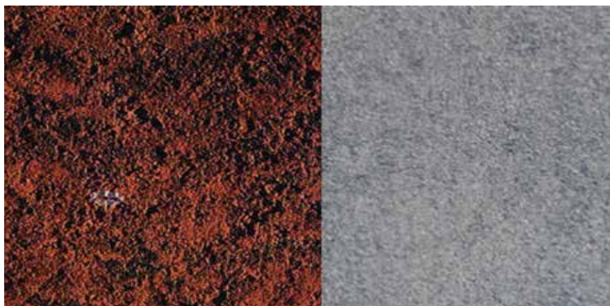
Obr. 2 - Výchozí stav vlevo, Sa 2,5 vpravo
