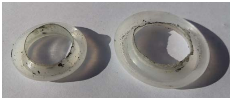
Obr. 2 - Deformované PE ucpávky
