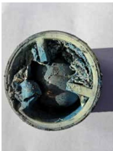
Obr. 1 - Důsledek reakce 2K barvy
